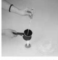
Βάλε στο μπρίκι λίγο νερό και πρόσθεσε δύο μεγάλα παγάκια. Ανακάτεψε καλά με το κουταλάκι. Στερέωσε ένα κέρι στο βραντί σου με πλαστελίνη και άναψε το. Κράτησε το μπρίκι πάνω από τη φλόγα του κεριού και μέτρα τη θερμοκρασία στο μπρίκι κάθε δύο λεπτά. Ανακάτεψε το νερό όση ώρα μέτρας τη θερμοκρασία. Τι παρατηρείς;
